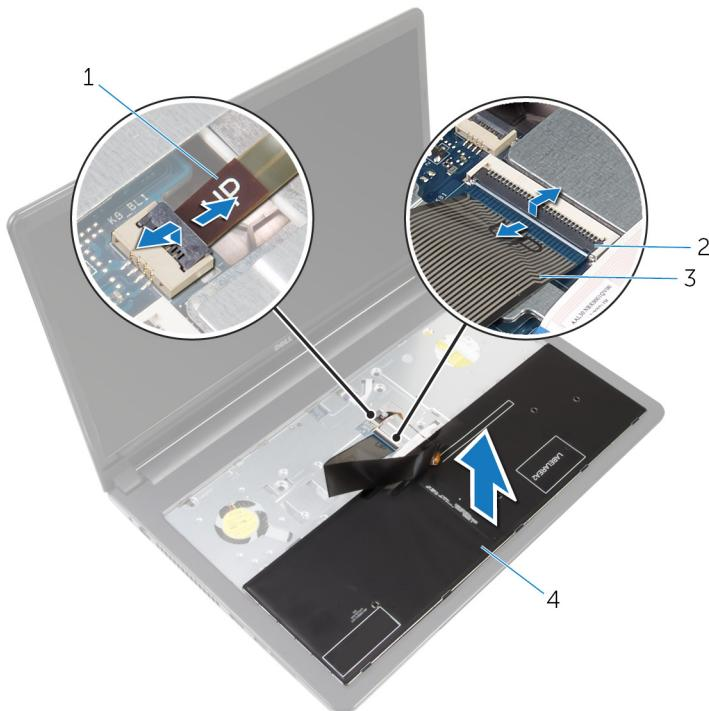
1 Kabel za osvetlitev
