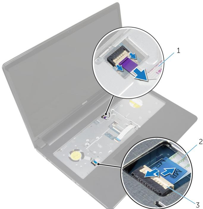
1 Kabel plošče gumba za vklop
